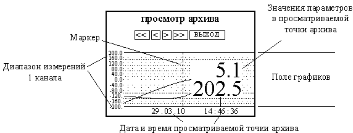
Рисунок 2.8 – Примерный вид ЖК-дисплея регистраторов при детальном просмотре блока архива значений параметров 1 канала
