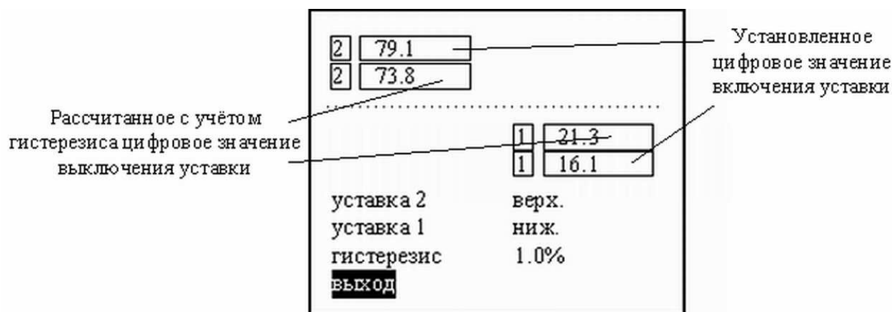
Рисунок 2.3 – Примерный вид меню вида уставок и гистерезиса с выбранным пунктом ВЫХОД
