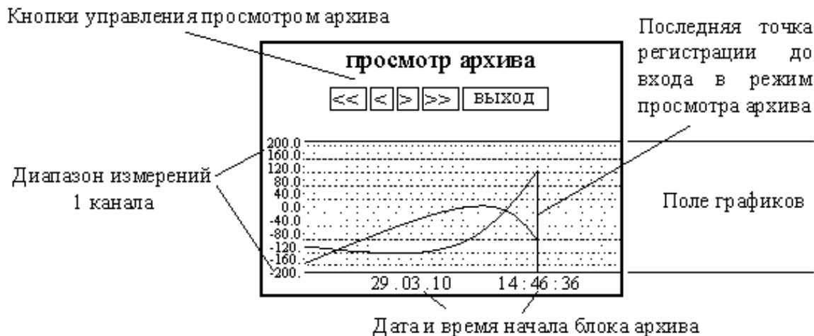
Рисунок 2.8 – Примерный вид ЖК-дисплея регистраторов при просмотре архива значений параметров 1 канала из последнего незаполненного блока архива
