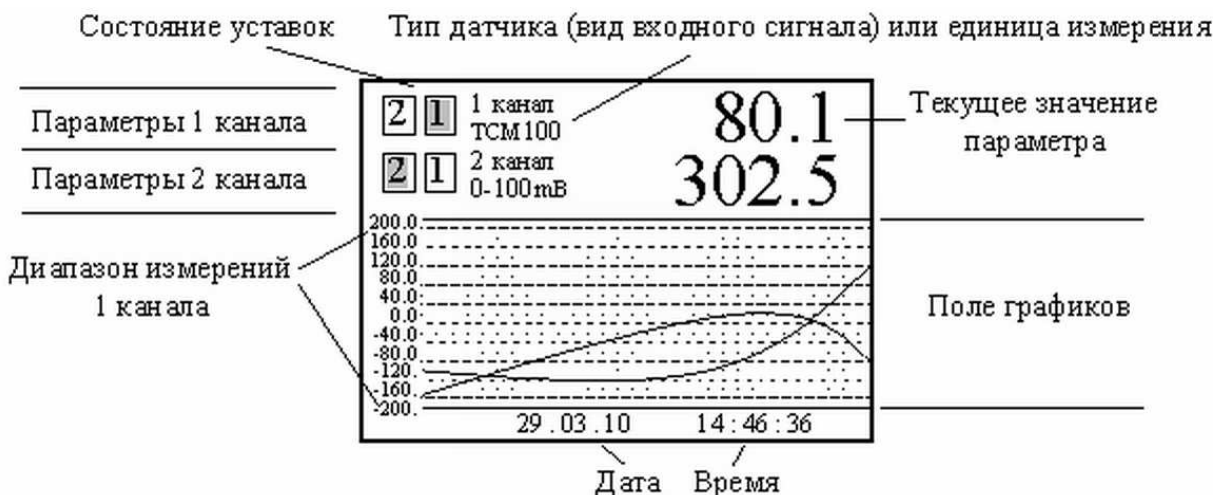
Рисунок 2.4 – Примерный вид ЖК-дисплея регистраторов в режиме отображения графиков при отображении графика 1 канала
