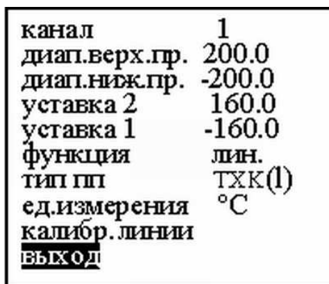
Рисунок 2.2 – Примерный вид меню ПАРАМЕТРЫ для первого канала регистраторов с выбранным пунктом ВЫХОД
